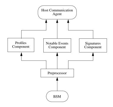
Figure 3.3 : Host Monitor Structure<sup>2</sup>
